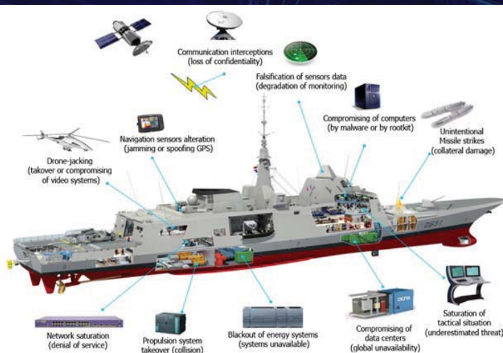
Εικόνα 1. Κυβερνοαπειλές σε ένα σύγχρονο πολεμικό πλοίο (Image courtesy of Naval Group)
